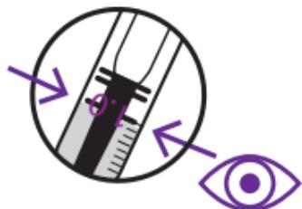
**5.** Ajouter le réactif MG-3 lentement et goutte par goutte en agitant légèrement (important !). Laisser goutter le réactif MG-3 jusqu'à ce que la solution devienne complètement grise ou bleue. Après 30 secondes, la coloration grise ou bleue doit être encore présente, sinon continuer à ajouter du MG-3 jusqu'à ce que la coloration grise ou bleue soit définitive.
