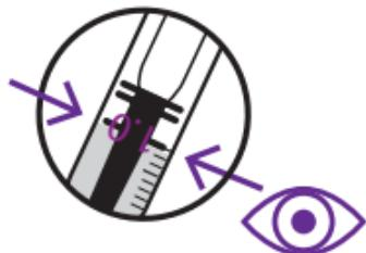
**5.** Langsam und tropfenweise unter leichtem Umschwenken (wichtig!) Reagenz CA-3 zugeben. Solange Reagenz CA-3 zutropfen, bis die Lösung vollständig nach blau umschlägt. Nach 30 Sekunden muss die Blaufärbung noch vorhanden sein, sonst bis zur endgültigen Blaufärbung weiter CA-3 zuzugeben.
