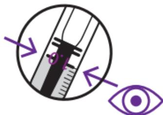
**5.** Ajouter le réactif CA-3 lentement et goutte par goutte en agitant légèrement (important!). Laisser goutter le réactif CA-3 jusqu'à ce que la solution devienne complètement bleue. Après 30 secondes, la coloration bleue doit être encore présente, sinon continuer à ajouter du CA-3 jusqu'à ce que la coloration bleue soit définitive.
